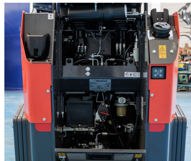
Accès arrière à la batterie et à la pompe.
