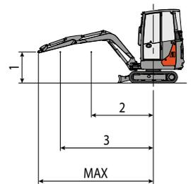
Hebekraft basierend auf ISO-Norm 10567 und überschreitet nicht mehr als 75% der Kippplast oder 87% der hydraulischen Hebe-Kapazität der Maschine.
