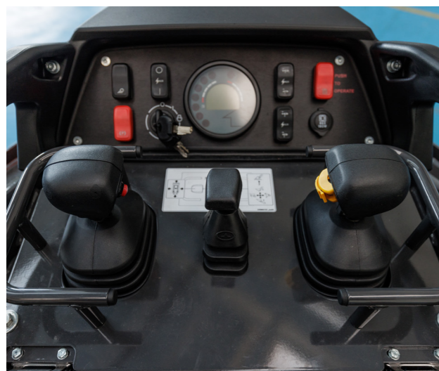
Cosole di comando con joystick idraulici pilotati.
