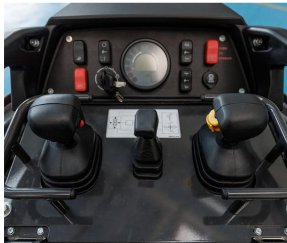
Steuerkonsole mit vorgesteuerten hydraulischen Joysticks.
