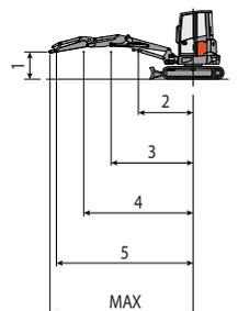
La capacità di sollevamento è basata sulla norma ISO 10567 e non eccede oltre il 75% del carico statico di ribaltamento o dell'87% della capacità di sollevamento idraulico della macchina.
