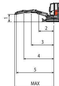
La capacità di sollevamento è basata sulla norma ISO 10567 e non eccede oltre il 75% del carico statico di ribaltamento o dell'87% della capacità di sollevamento idraulico della macchina.
