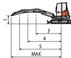
La capacità di sollevamento è basata sulla norma ISO 10567 e non eccede oltre il 75% del carico statico di ribaltamento o dell'87% della capacità di sollevamento idraulico della macchina.
