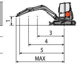
La capacité de levage est basée sur la norme ISO 10567 et elle ne dépasse pas au-delà du 75% du charge statique de basculement ou au-delà du 87% de la capacité de levage hydraulique de la machine.
