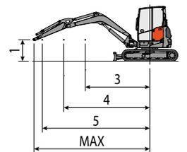
Hebekraft basierend auf ISO-Norm 10567 und überschreitet nicht mehr als 75% der Kippplast oder 87% der hydraulischen Hebe-Kapazität der Maschine.
