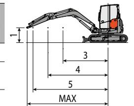
Hebekraft basierend auf ISO-Norm 10567 und überschreitet nicht mehr als 75% der Kippplast oder 87% der hydraulischen Hebe-Kapazität der Maschine.
