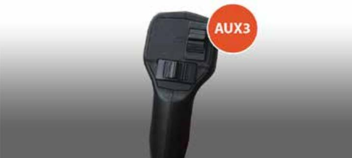
Roller elettroidraulico proporzionale per impianto idraulico ausiliario su Joystick sinistro (modelli Tier3)
