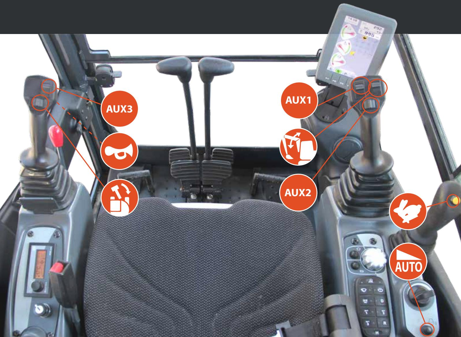
I comandi di brandeggio, il braccio triplice nella versione TR, il braccio deportè nella versione UR e gli impianti idraulici ausiliari, sono tutti controllati attraverso comodi e precisi roller elettroidraulici proporzionali posizionati sui Joystick.
