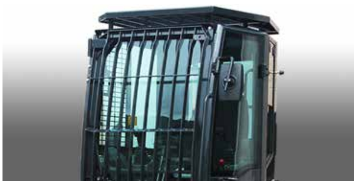
Griglie aggiuntive anteriore e superiore di protezione certificate FOPS livello2
