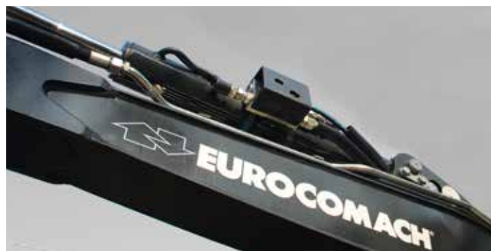
Gancio di sollevamento certificato e omologato e valvole di blocco con certificazione CE per attrezzature movimentazione materiale
