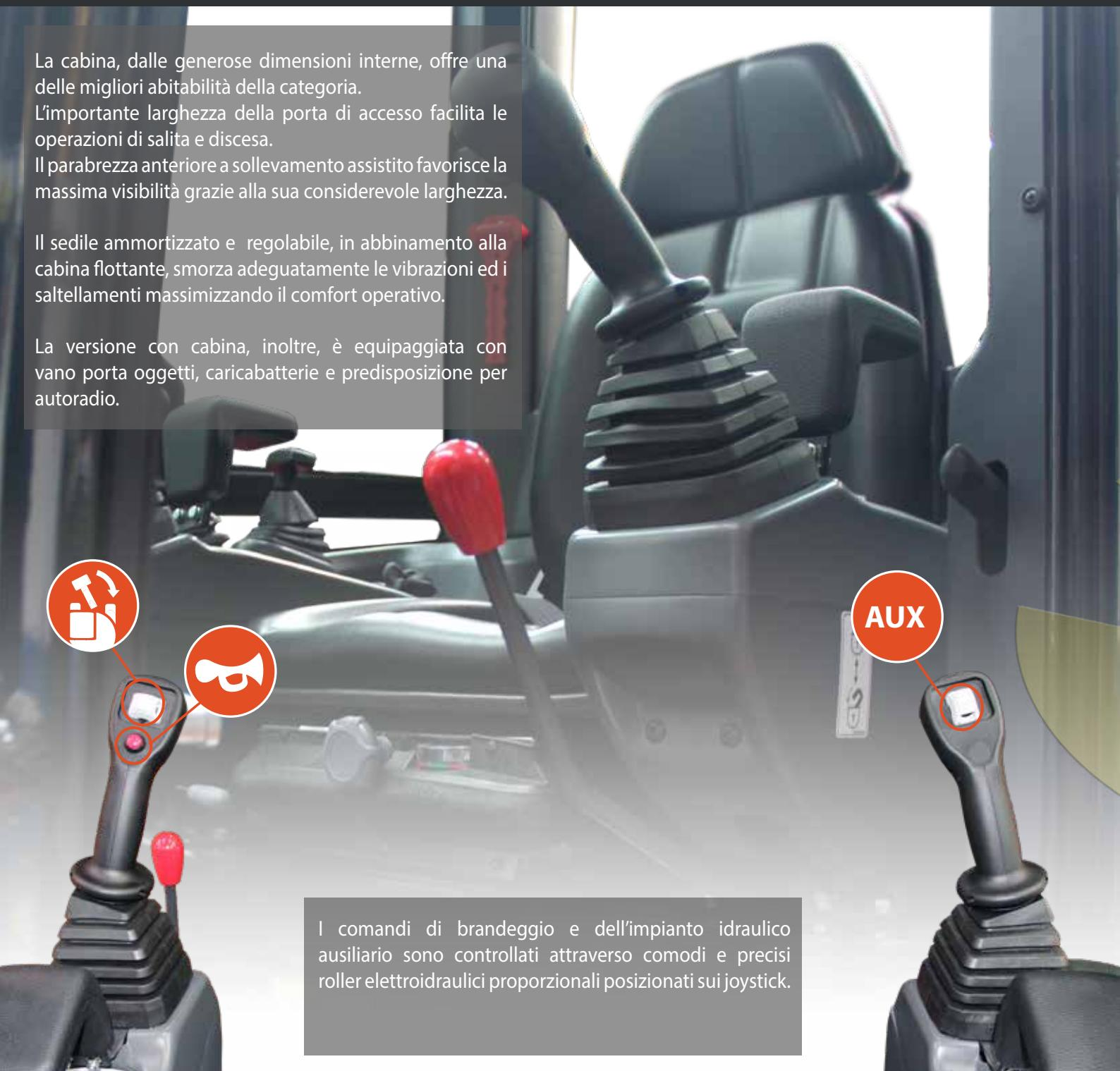
I comandi di brandeggio e dell'impianto idraulico ausiliario sono controllati attraverso comodi e precisi roller elettroidraulici proporzionali posizionati sui joystick.
