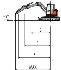
La capacité de levage est basée sur la norme ISO 10567 et elle ne dépasse pas au-delà du 75% du charge statique de basculement ou au-delà du 87% de la capacité de levage hydraulique de la machine.
