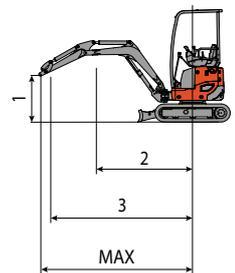
La capacité de levage est besée sur la norme ISO 10567 est elle ne dépasse pas au-delà du 75% du charge statique de basculement ou audelà du 87% de la capacité de levage hydraulique de la machine.
