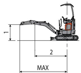
La capacité de levage est basée sur la norme ISO 10567 et elle ne dépasse pas au-delà du 75% du charge statique de basculement ou au-delà du 87% de la capacité de levage hydraulique de la machine.
