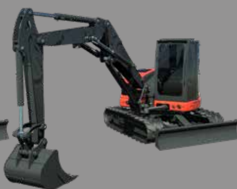
Versione TR Braccio triplice con brandeggio.
