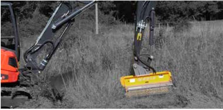
Circuit hydraulique simple/double effet avec retenue électrique (70 l/min)
