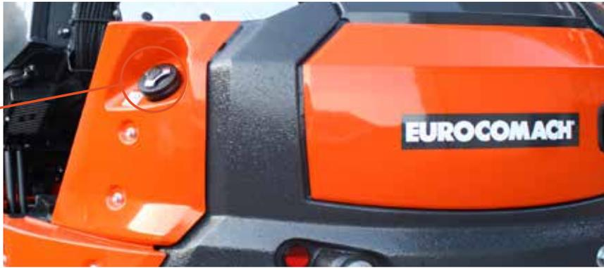
Le capot postérieur permet l'accès rapide à la pompe électronique de remplissage gazole et au distributeur hydraulique.
