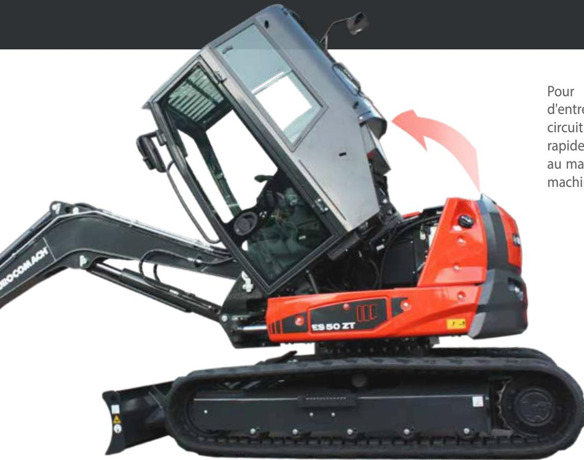
Pour effectuer des interventions d'entretien supplémentaire sur le circuit hydraulique, le renversement rapide et pratique de la cabine limite au maximum les temps d'arrêt de la machine.
