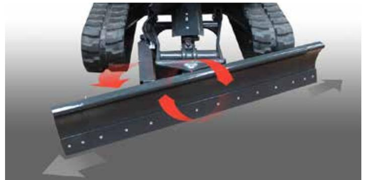
Lame de comblement angle tilt dozer hydraulique avec rallonges et contre-lame boulonnée supplémentaire
