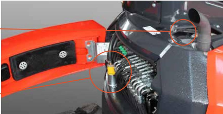
Un logement porte-outils pratique est à disposition de l'opérateur sur le côté d'entrée de la machine. Tous les points d'accès pour les contrôles quotidiens et pour les interventions d'entretien courant sont concentrés dans des zones définies, en permettant l'optimisation des temps d'arrêt machine.
