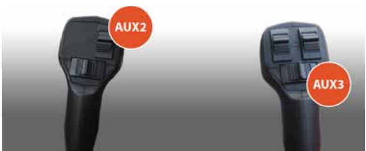
Roller elettroidraulici proporzionali per impianti idraulici ausiliari su entrambi i joystick
