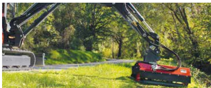
Impianto idraulico singolo/doppio effetto con ritenuta elettrica (50 lt/min)
