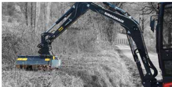
Circuit hydraulique simple/double effet avec retenue électrique (50 l/min)
