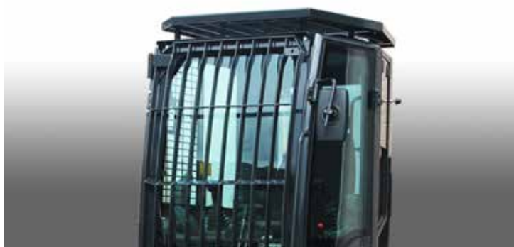
Grilles supplémentaires antérieure et supérieure de protection certifiées FOPS niveau2
