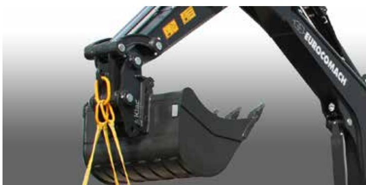
Crochet de levage certifié et homologué et soupapes de blocage avec certification CE pour équipements de manutention matériel
