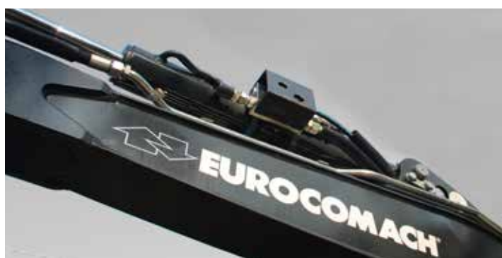
Crochet de levage certifié et homologué et soupapes de blocage avec certification CE pour équipements de manutention matériel
