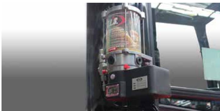
Graissage automatique centrassilé
