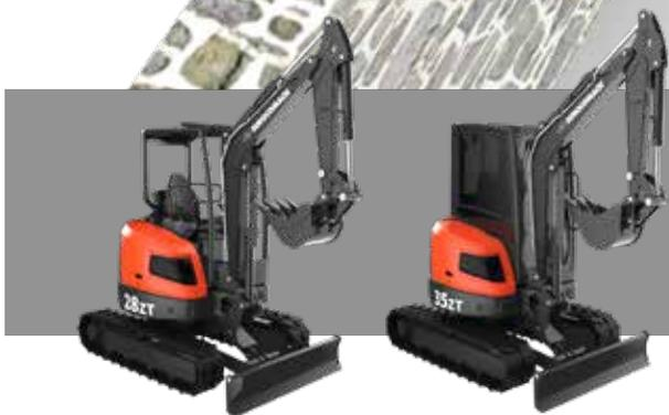
Entrambi i modelli possono essere dotati di roll-bar di protezione a quattro montanti o cabina.
