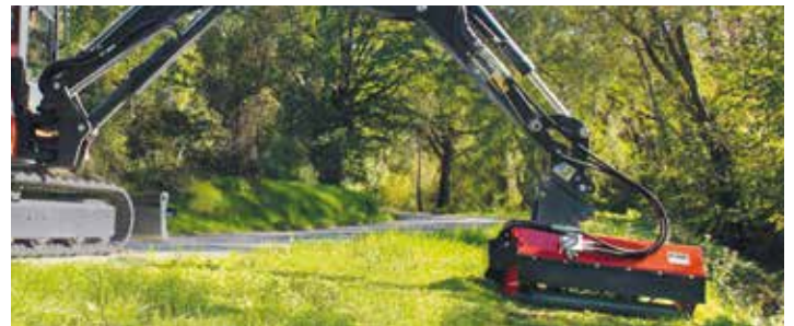
Instalación hidráulica simple/doble efecto con retención eléctrica (50 lt/min)
