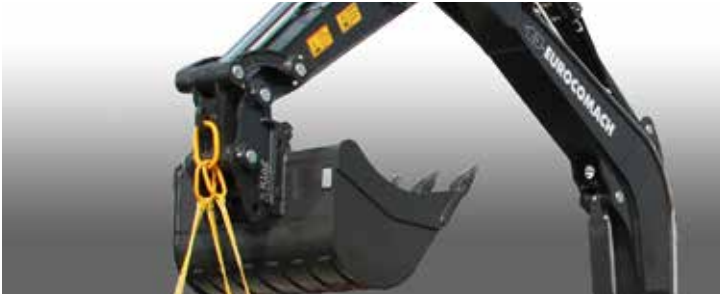
Gancho de levantamiento certificado y homologado y válvulas de bloqueo con certificación CE para equipos de movilización material
