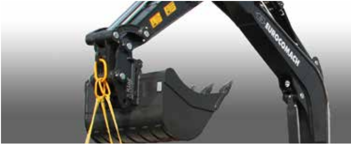
Zertifizierter und homologierter Lasthaken und Sperrventile mit CE-Zertifizierung für die Ausrüstung zur Material-Handhabung
