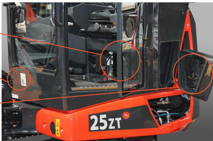
L'alloggiamento dei filtri ventilazione cabina consente un immediato controllo e l'eventuale sostituzione degli stessi.
