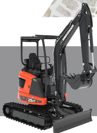
Questo modello può essere dotato di roll-bar di protezione a quattro montanti o cabina. La scelta permette una versatilità senza eguali: ingombro minimo per prestazioni al massimo.
