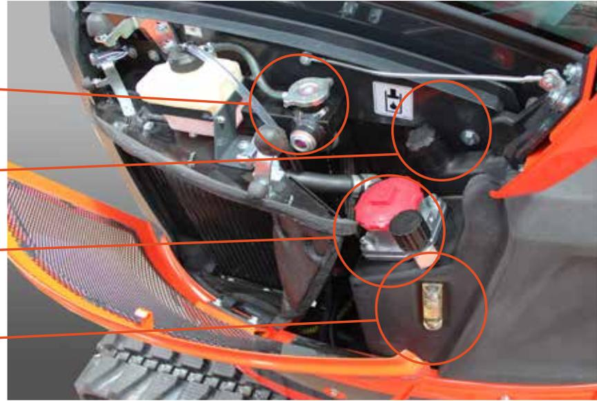
Todos los puntos de acceso para los controles diarios y para las operaciones de mantenimiento ordinario están concentrados en áreas definidas, permitiendo la optimización de los tiempos de detención de la máquina.
