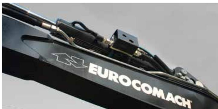
Gancho de levantamiento certificado y homologado y válvulas de bloqueo con certificación CE para equipos de movilización material
