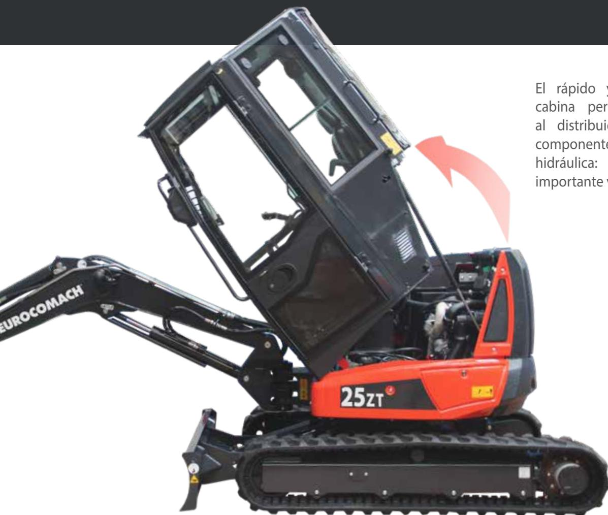
El rápido y práctico vuelco de la cabina permite acceder fácilmente al distribuidor y a los principales componentes de la instalación hidráulica: pocos gestos para un importante valor adicional.
