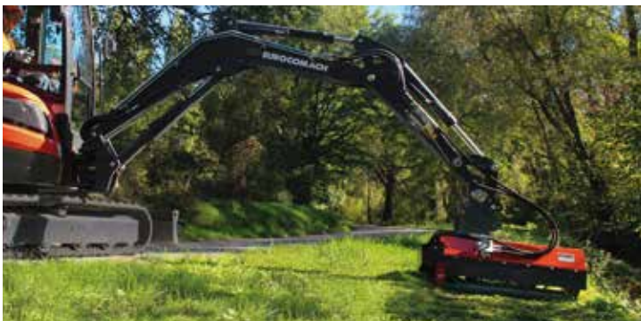
Hydraulikanlage für Mulcher mit zusätzlicher Pumpe (22 l/Min.)
