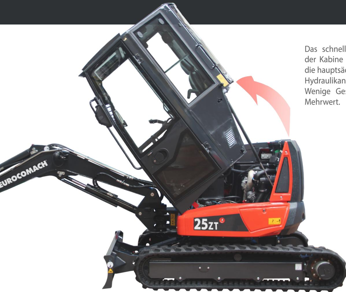
Das schnelle und praktische Kippen der Kabine erlaubt, den Verteiler und die hauptsächlichen Komponenten der Hydraulikanlage bequem zu erreichen: Wenige Gesten für einen wichtigen Mehrwert.
