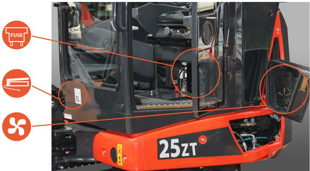
Die Aufnahme der Filter der Kabinenlüftung erlaubt eine umgehende Kontrolle und einen eventuellen Austausch derselben.
