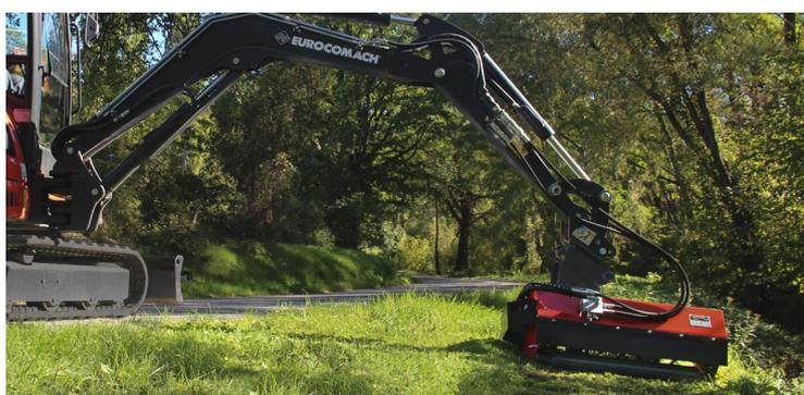
Hydraulikanlage für Mulcher mit zusätzlicher Pumpe (22 l/Min.)
