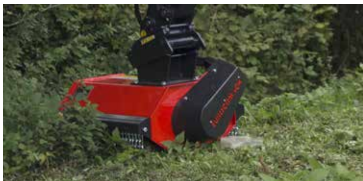
Impianto idraulico per trincia con pompa supplementare (20 lt/min)
