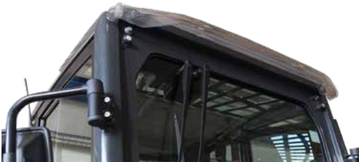
Visera delantera cabina en plexiglás
