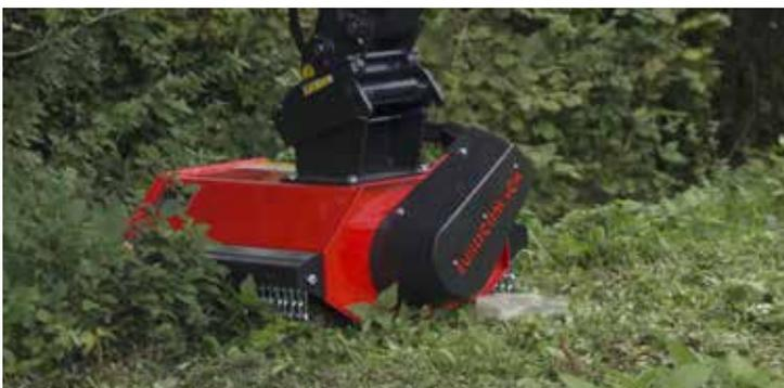
Mucherhydraulik mit Zusatzpumpe (20lt/min)
