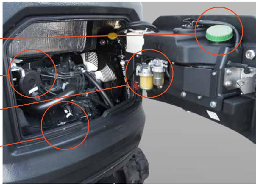
Die seitlich zu öffnende Motorhaube erleichtert die Überprüfung und Reinigung der Kühler und des Hydraulikölfilters.
