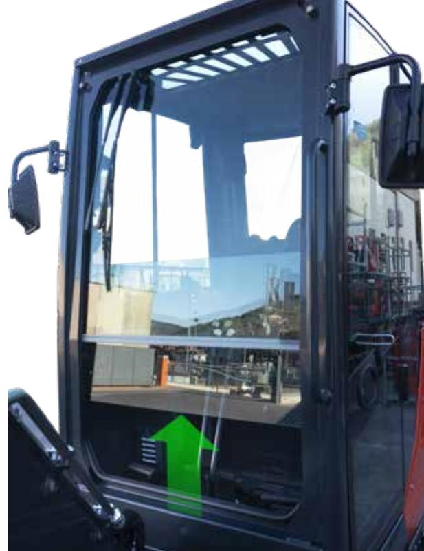
Die seitlichen Schiebefenster und die Frontscheibe mit Anhebehilfe (über Gasfedern) gewährleisten dem Bediener eine maximale Sicht und Belüftung.
