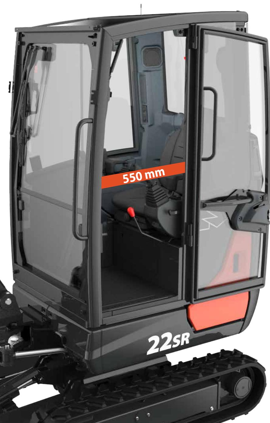
Der breite Einstieg (550 mm) erlaubt es dem Fahrer bequem in die Kabine ein- und auszusteigen. Dies gewährleistet eine Zugänglichkeit wie bei Maschinen einer höheren Kategorie.
