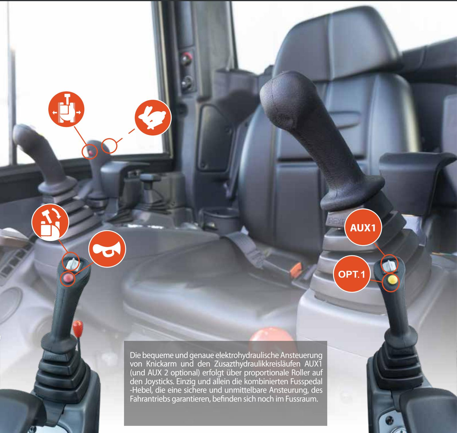
Die bequeme und genaue elektrohydraulische Ansteuerung von Knickarm und den Zusazhydraulikkreisläufen AUX1 (und AUX 2 optional) erfolgt über proportionale Roller auf den Joysticks. Einzig und allein die kombinierten Fusspedal-Hebel, die eine sichere und unmittelbare Ansteuerung, des Fahrtriebs garantieren, befinden sich noch im Fussraum.
