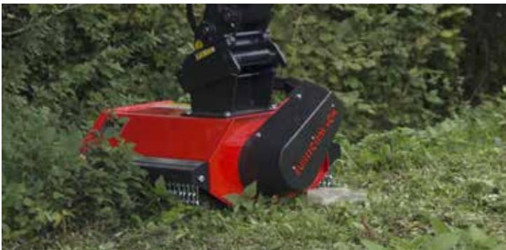
Système hydraulique pour hacheuse avec pompe supplémentaire (20 l/min)
