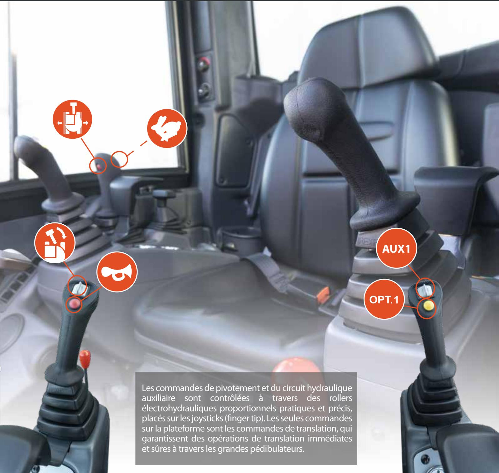
Les commandes de pivotement et du circuit hydraulique auxiliaire sont contrôlées à travers des rollers électrohydrauliques proportionnels pratiques et précis, placés sur les joysticks (finger tip). Les seules commandes sur la plateforme sont les commandes de translation, qui garantissent des opérations de translation immédiates et sûres à travers les grandes pédibulateurs.
