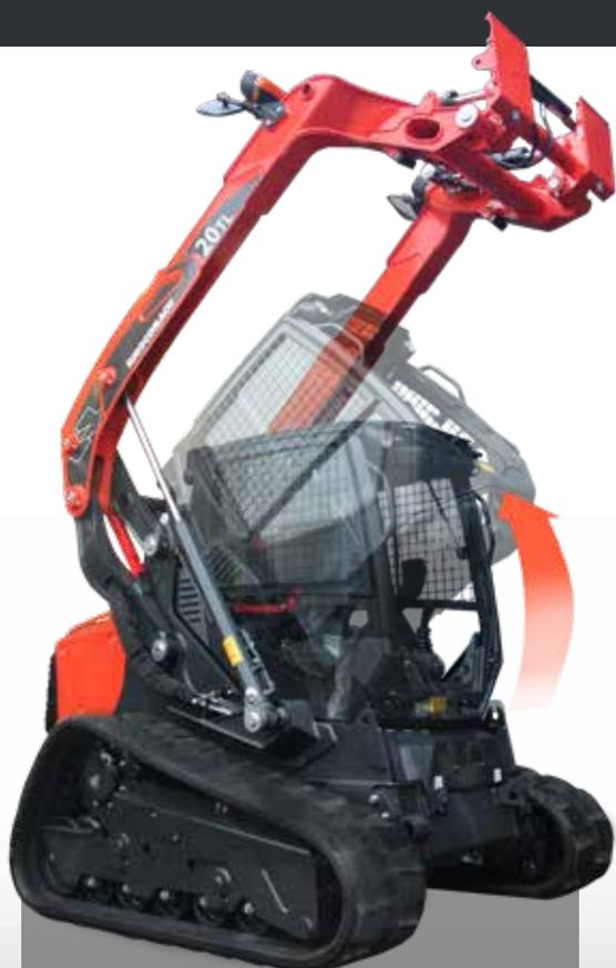
Le renversement de la cabine à commande hydraulique permet d'accéder facilement au distributeur et aux éléments principaux: quelques gestes pour une importante valeur ajoutée.
