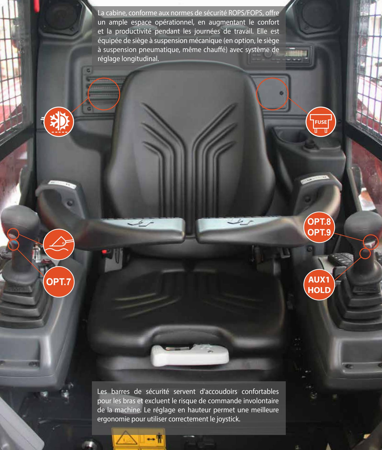
Les barres de sécurité servent d'accoudoirs confortables pour les bras et excluent le risque de commande involontaire de la machine. Le réglage en hauteur permet une meilleure ergonomie pour utiliser correctement le joystick.
