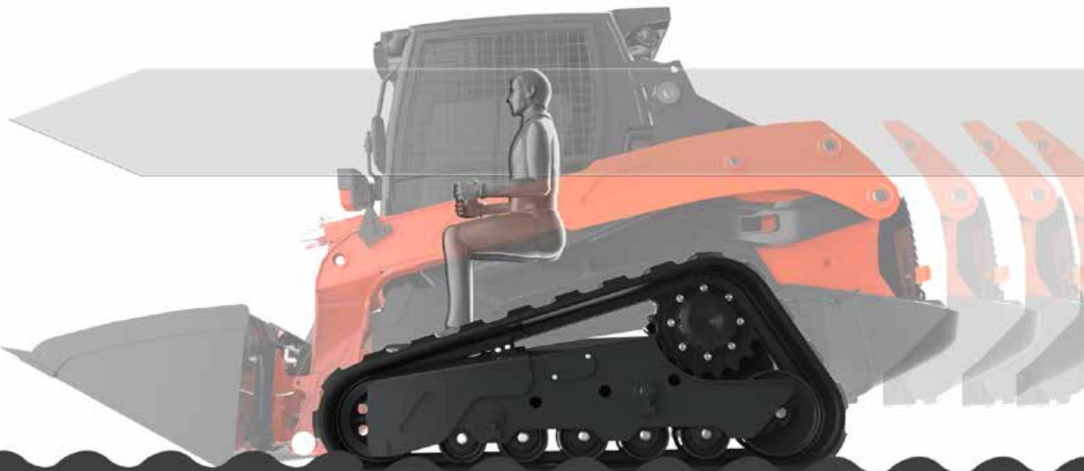
La cabine, conforme aux normes de sécurité ROPS/FOPS, offre un ample espace opérationnel, en augmentant le confort et la productivité pendant les journées de travail. Elle est équipée de siège à suspension mécanique (en option, le siège à suspension pneumatique, même chauffé) avec système de réglage longitudinal.
