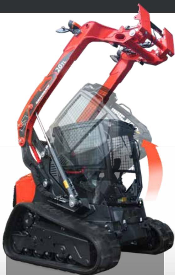
El vuelco de la cabina de accionamiento hidráulico permite acceder fácilmente al distribuidor y a los componentes principales: unos pocos gestos para un valor añadido importante.
