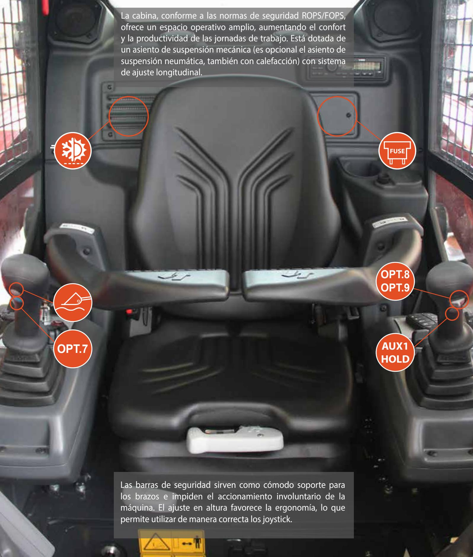
Las barras de seguridad sirven como cómodo soporte para los brazos e impiden el accionamiento involuntario de la máquina. El ajuste en altura favorece la ergonomía, lo que permite utilizar de manera correcta los joystick.
