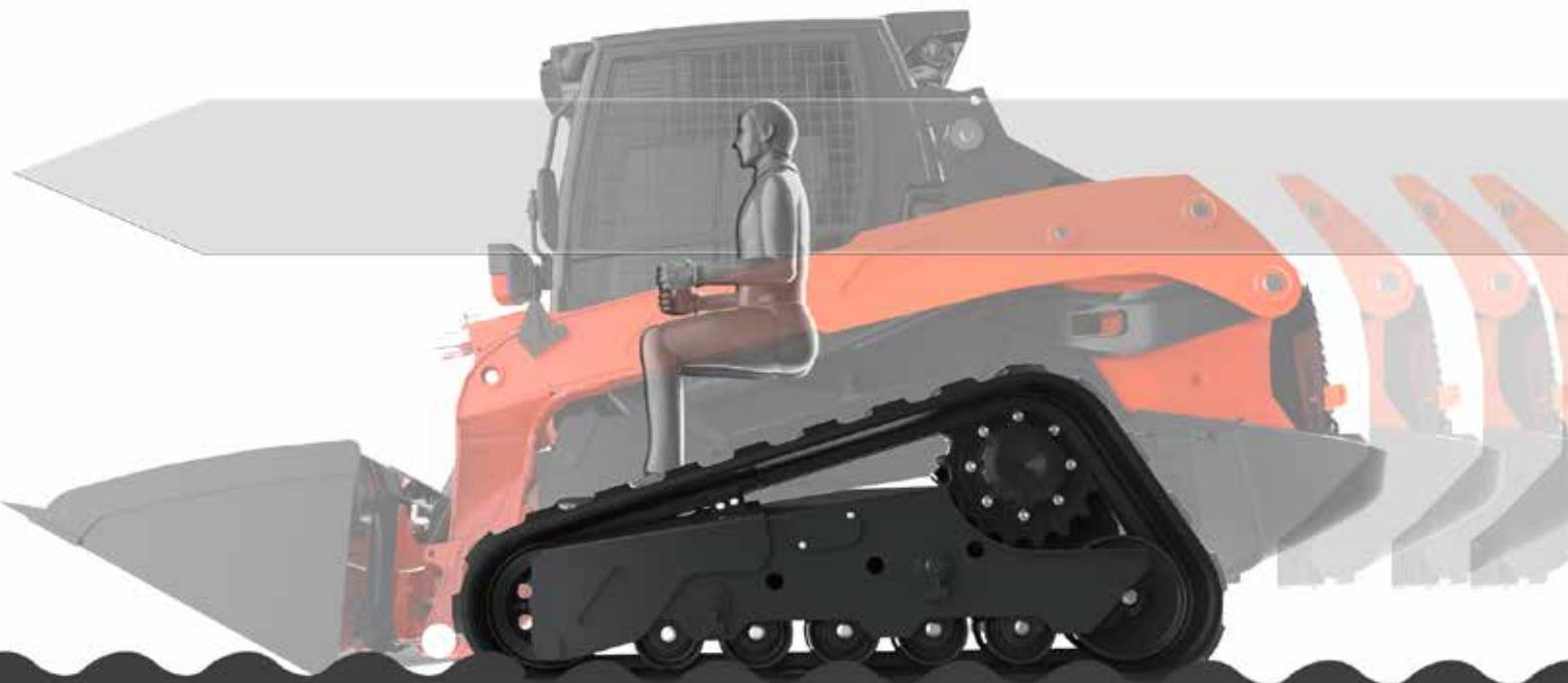
La cabina, conforme a las normas de seguridad ROPS/FOPS, ofrece un espacio operativo amplio, aumentando el confort y la productividad de las jornadas de trabajo. Está dotada de un asiento de suspensión mecánica (es opcional el asiento de suspensión neumática, también con calefacción) con sistema de ajuste longitudinal.
