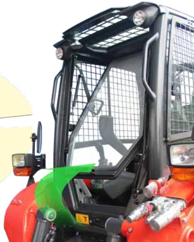
Dank der weiten vorderen Öffnung (versenkbar zu öffnen) erweist sich der Zugang zum Fahrersitz als bequem und umgehend, ohne Hindernisse. Die Möglichkeit für den Bediener, sowohl mit geschlossener als auch offener Türe in größter Ruhe arbeiten zu können, stellt einen zusätzlichen Wert dar.
