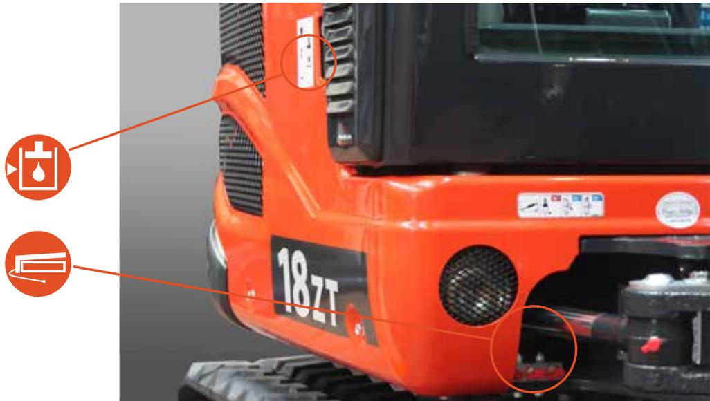
Batería, fusibles y rellenado de aceite hidráulico se pueden alcanzar mediante los adecuados compartimientos en la parte delantera del puesto de conducción.
