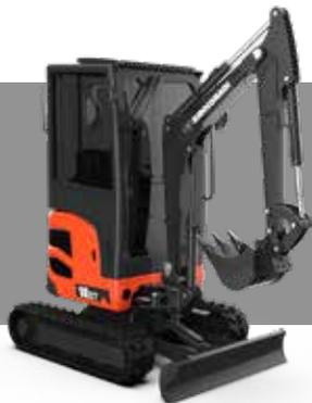
Este modelo se puede equipar con canopy de protección con cuatro montantes o cabina. La elección permite una versatilidad sin comparaciones: dimensiones mínimas para rendimientos máximos.
