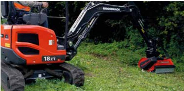
Instalación hidráulica para picadora con bomba suplementaria (19 lt/min)
