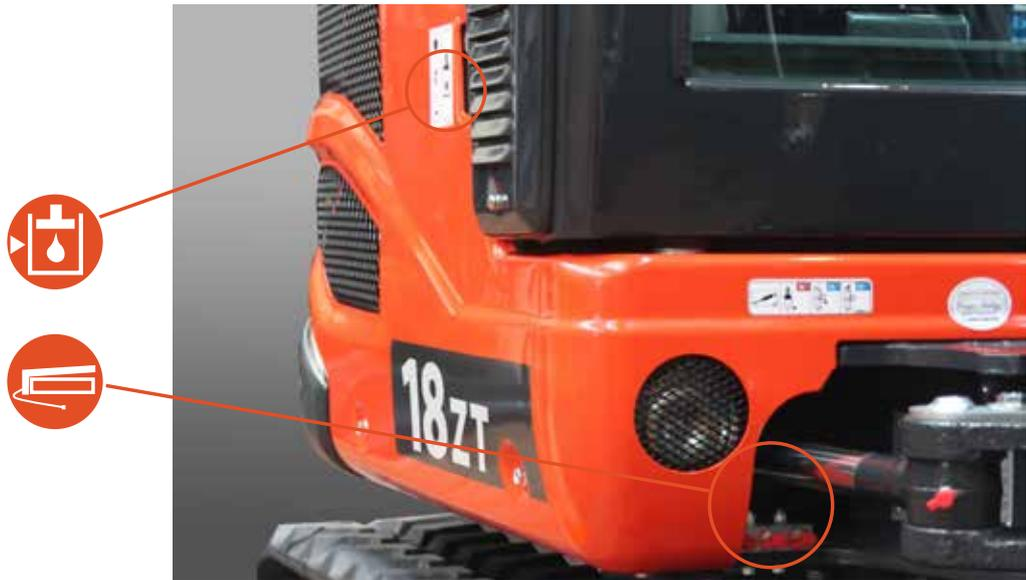
Batteria, fusibili, e rabbocco olio idraulico sono raggiungibili attraverso appositi vani sulla parte anteriore del posto guida.
