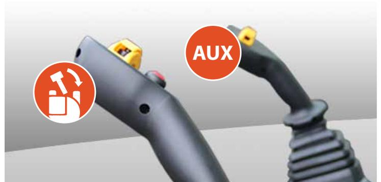
Préparation circuit hydraulique auxiliaire avec commande électrohydraulique proportionnelle sur Joystick
