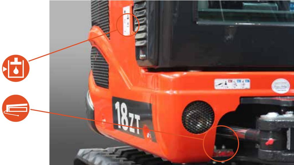
Batterie, fusibles, et remise à niveau huile hydraulique peuvent être atteints à travers des logements spécifiques sur la partie antérieure du poste de conduite.
