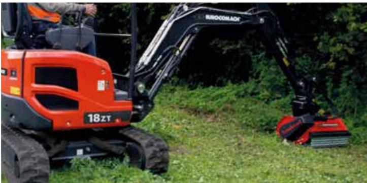
Circuit hydraulique pour tête tranchante avec pompe supplémentaire (19 l/min)
