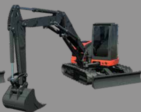
Versione TR Braccio triplice con brandeggio.
