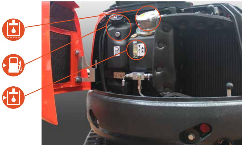
Les services relatifs au moteur thermique sont aisément atteignables à travers une ample ouverture du capot latéral.
