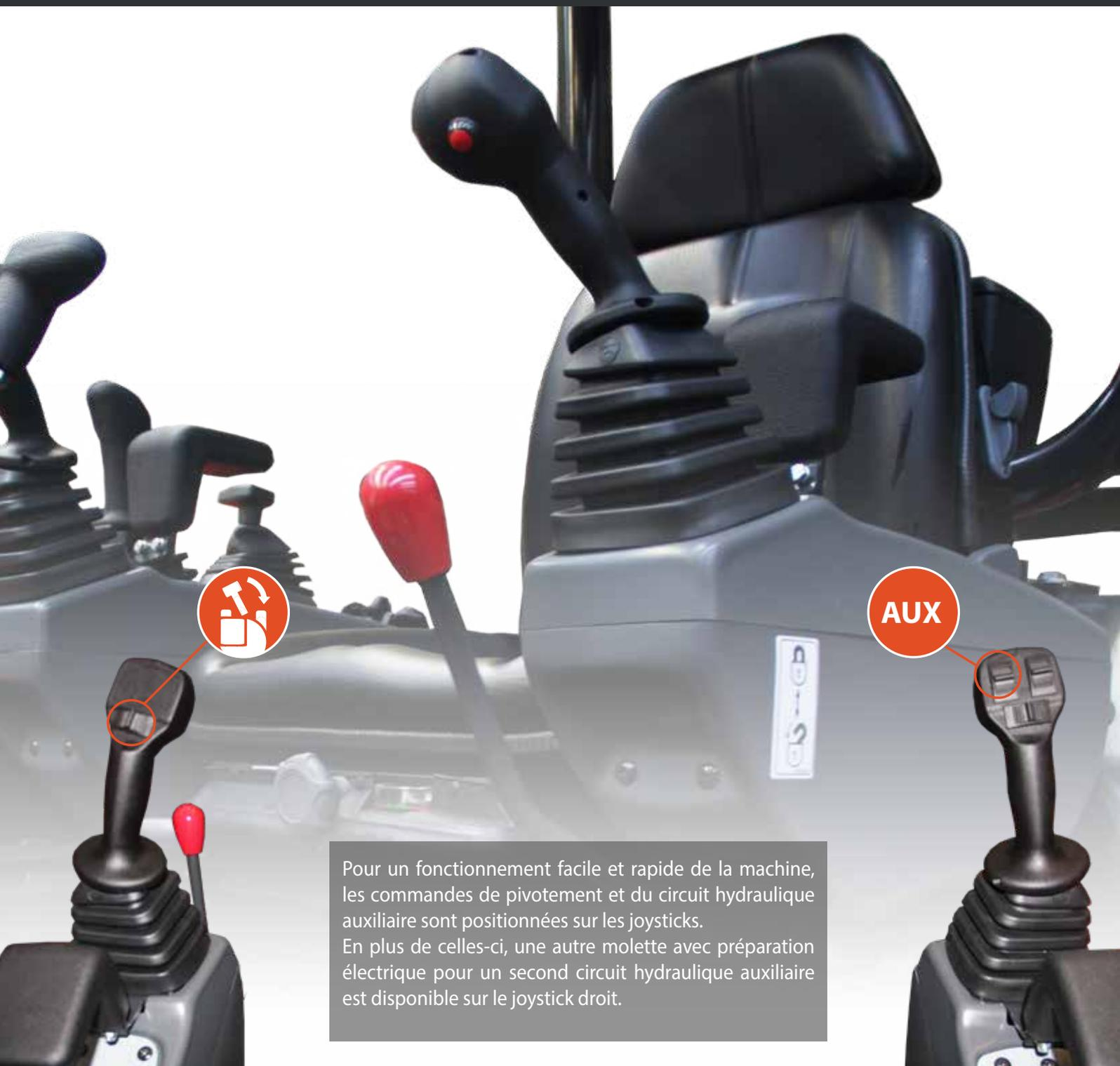
Pour un fonctionnement facile et rapide de la machine, les commandes de pivotement et du circuit hydraulique auxiliaire sont positionnées sur les joysticks. En plus de celles-ci, une autre molette avec préparation électrique pour un second circuit hydraulique auxiliaire est disponible sur le joystick droit.
