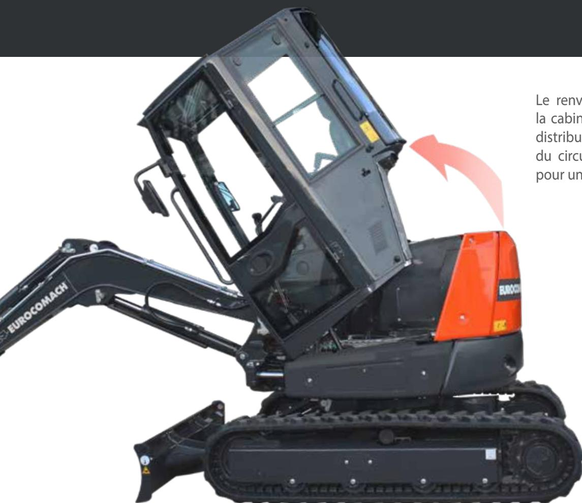
Le renversement rapide et pratique de la cabine permet d'accéder aisément au distributeur et aux principaux composants du circuit hydraulique: quelques gestes pour une importante valeur ajoutée.
