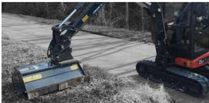
Impianto idraulico per trincia con pompa supplementare (22 lt/min)
