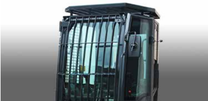
Griglie aggiuntive anteriore e superiore di protezione certificate FOPS livello2
