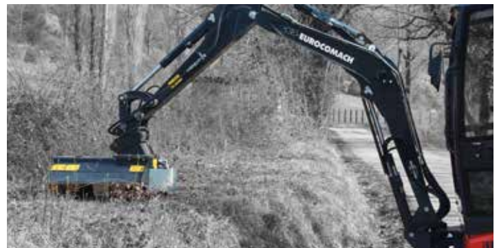
Hydraulikanlage, einfach/doppelwirkend mit elektrischen vorgesteuertem Nachlass (50 l/Min.)
