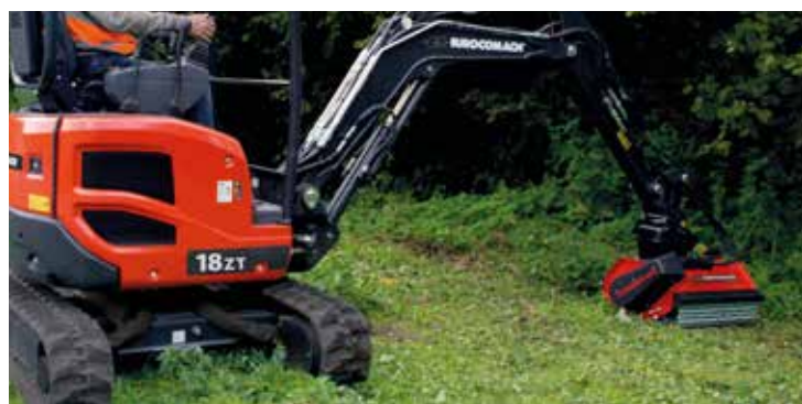
Impianto idraulico per trincia con pompa supplementare (19 lt/min)
